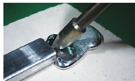
Obr. 2 Extravýkonný 300W kompaktní pájecí hrot
