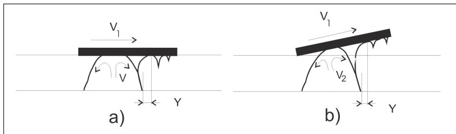
Obr. 1 a) pohyb DPS vlnou a vznik závoje, b) eliminace závoje náklonem pohybu DPS
