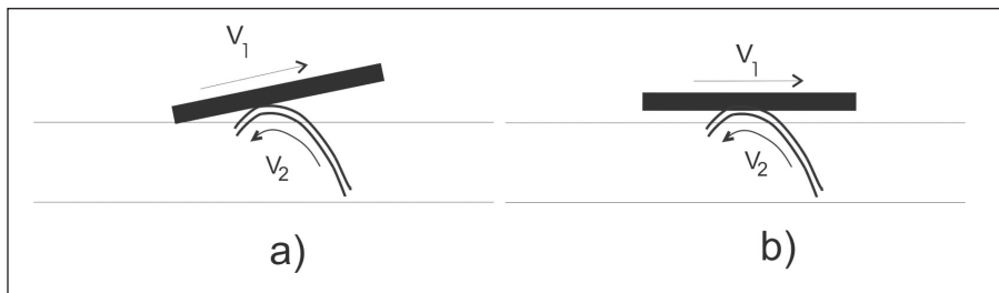
Obr. 2 a) tzv. dutá vlna, která jde proti směru pohybu DPS, b) použití duté vlny při pohybu DPS horizontálně
